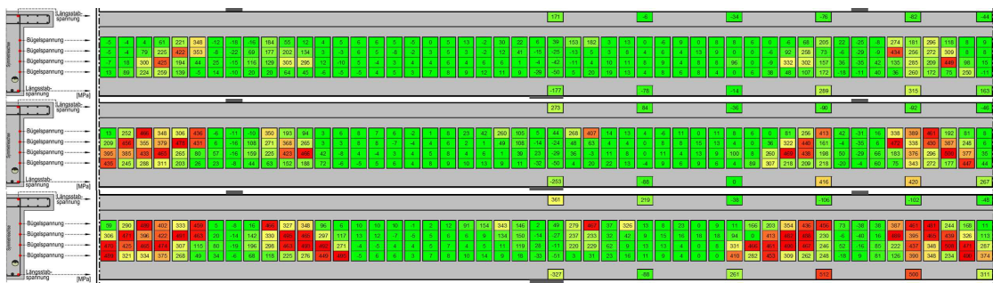
Gemessene Bügelspannung \sigma [MN/m 2 ] bei Pressenkräften von 1200 / 1400 / 1540 kN BAST Heft B 150, A.2.2.1 (c), (d), (e)
